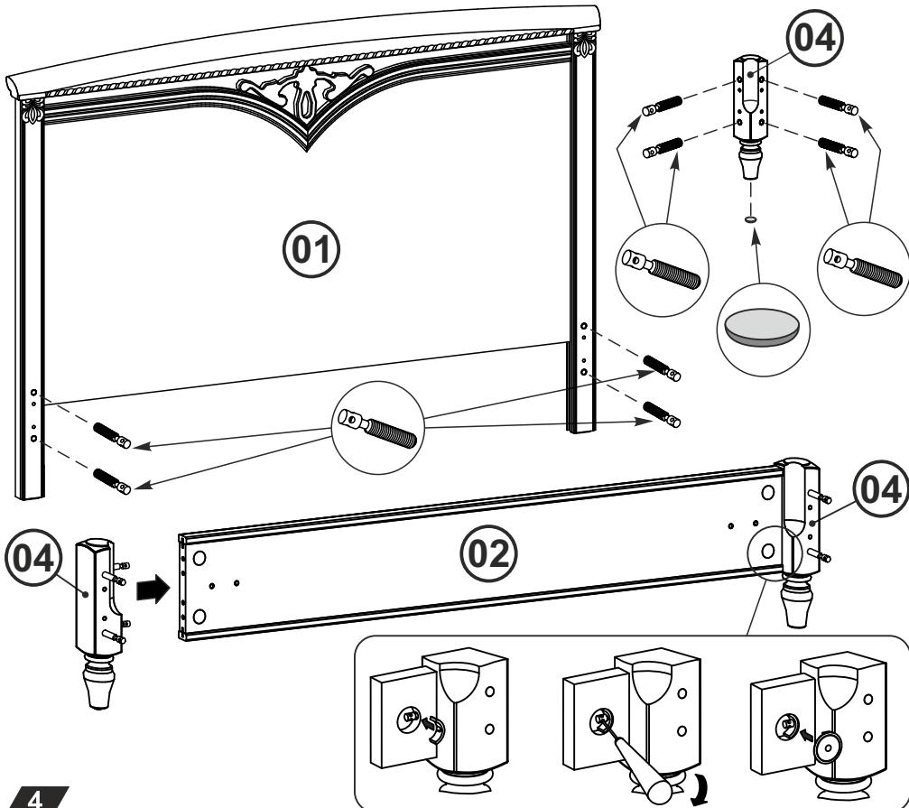
Порядок сборки сегментных стяжек: в отверстия царги 02 вставить сегменты и с помощью шила завернуть винты до упора. В отверстия вставить заглушки.
